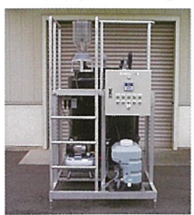
微生物製剤投入ユニット
