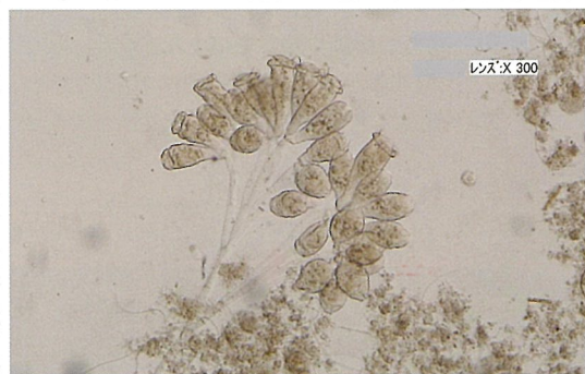
フロック(凝集した汚泥)の状態、菌叢から排水処理運転の状態を判断
